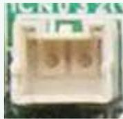
Cable para operar el ventilador Inverter externo.
