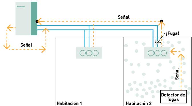
**Método directo de detección de fugas: Algoritmo PLC único para determinar la fuga de refrigerante**
