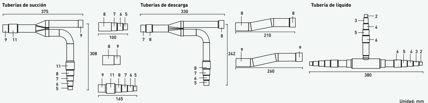
3. CZ-P224BH2BM: Para unidad interior (la capacidad a partir de la junta de distribución es de hasta 22,4 kW).
