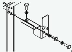
Kit de apilamiento para apilar en vertical hasta 3 intercambiadores de calor de agua (4 uds. por kit).
