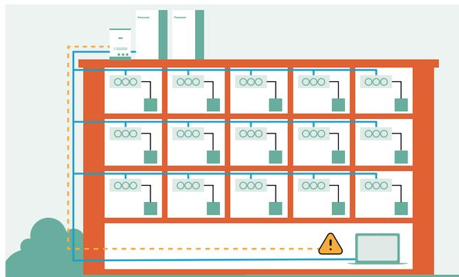
Fig. 2: Sistema independiente de detección de fugas.
