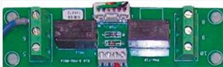
**PCB de interfaz T10 con conexiones digitales y de relé.**
