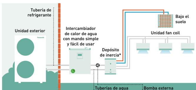
\* Volumen mínimo del depósito de inercia: 10 L/kW.
