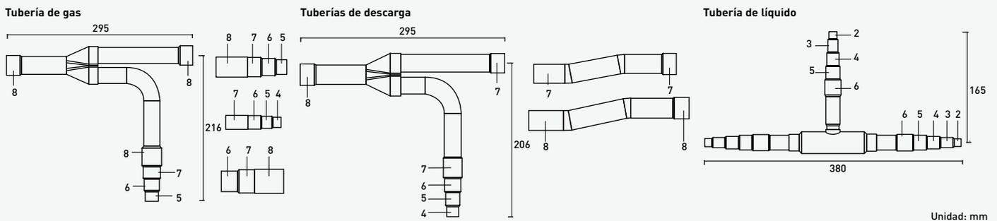
2. CZ-P1350PJ2BM: Para unidad exterior (la capacidad a partir de la junta de distribución es desde 68,0 kW a 135,0 kW).
