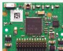
**Módulo inalámbrico ZigBee® / tarjeta Green Com.**
